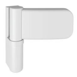
Die stufenlose 3D-Verstellung: Höhe - 1 mm / + 5 mm Seite +/- 5 mm, Andruck bis zu +/- 2mm Verstellungen mit Inbusschlüssel SW 4 Continous 3D adjustment: Height: - 1 mm / + 5 mm Side +/- 5 mm, Depth up to +/- 2 mm Adjustment with 4 mm Allen key
